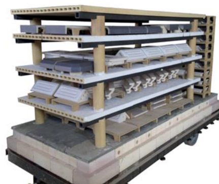
Plaques extrudées (plaques creuses) 1850 x 850 x 38 mm
