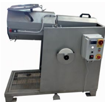
Broyeur avec jarre de 25 litres en différentes positions MGS25S01
