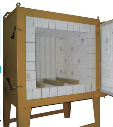
Four gaz HGRTI-252S porte ouverte
